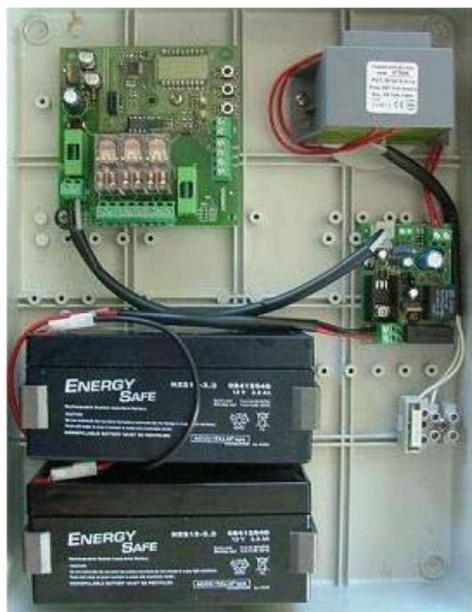
Verze s transformátorem, bateriemi a nabíječkou baterií
